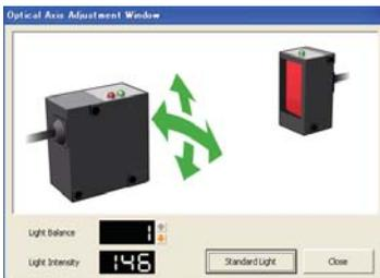
**4** Завершив центровку обеих оптических осей, щелкните кнопку [Standard Light] (Стандартный свет). Текущие настройки будут зарегистрированы в качестве образцовой интенсивности принимаемого света.
