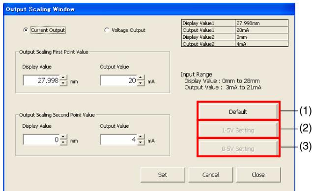
Обязательно выберите тот же режим, что выбран с помощью переключателя «ток/напряжение» с тыльной стороны контроллера.
