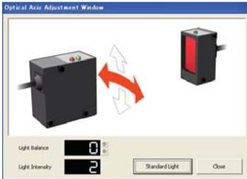
**2** Перемещая излучатель влево и вправо, отрегулируйте интенсивность принимаемого света, одновременно контролируя состояние горизонтальной стрелки. Когда оптическая ось будет отъюстирована, стрелка изменит цвет с красного на зеленый.
