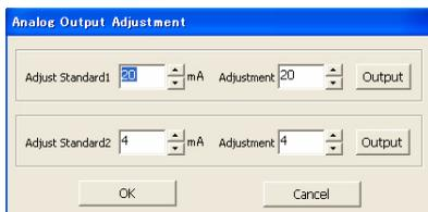
Подключите к аналоговому выходу внешний амперметр или вольтметр и выполните указанные ниже действия.
