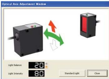
**3** Перемещая излучатель вверх и вниз, отрегулируйте интенсивность принимаемого света, одновременно контролируя состояние вертикальной стрелки. Перемещайте излучатель в направлении стрелки красного цвета. Когда оптическая ось будет отъюстирована, стрелка изменит цвет с красного на зеленый.
