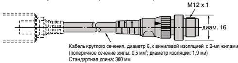
**Встроенный кабель с разъемом (-M1J/M1GJ)**
