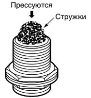
(2) Если стружки (металлические частицы) прессуются на рабочей поверхности (см. рисунок).
