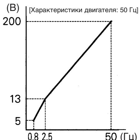
При работе с частотой свыше 60/50 Гц измените только максимальную выходную частоту (n011).
