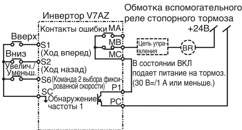
В случае цепи управления переменного тока подавайте сигналы P1 и PC в цепи управления при помощи реле. Проектируйте схему управления таким образом, чтобы при наступлении условий срабатывания контакт стопорного тормоза размыкался, а контакт между клеммами P1 и PC – замыкался (ВКЛ). Если сигнал аварийной остановки или сигнал на релейном выходе сигнализации ошибки инвертора находится в состоянии ВКЛ, контакт стопорного тормоза должен быть замкнут.
