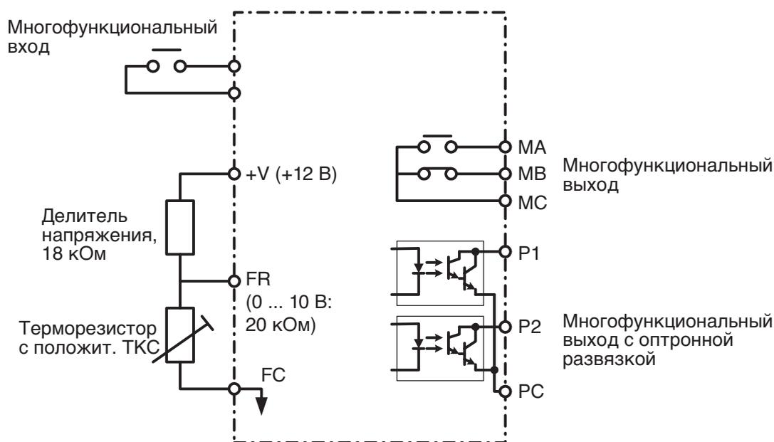
Примечание: Если для защиты двигателя от перегрева используется сигнал от терморезистора с положительным ТКС, обязательно переведите DIP-переключатель SW2 «Ток/Напряжение» на плате управления в положение V (Напряжение).
