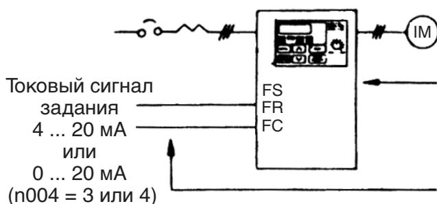
Для пуска или остановки инвертора нажмите соответствующую клавишу на цифровой панели управления. Направление вращения контролируется по светодиодному индикатору F/R (вперед/назад).
