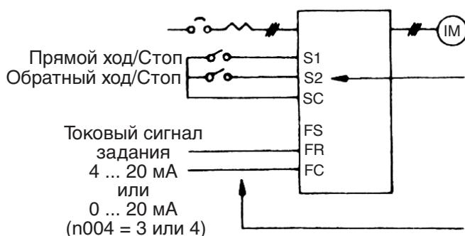
Переключение режимов «ход»/«останов» и «вперед»/«назад» осуществляется при помощи коммутационного устройства, подключенного к клеммам схемы управления.
