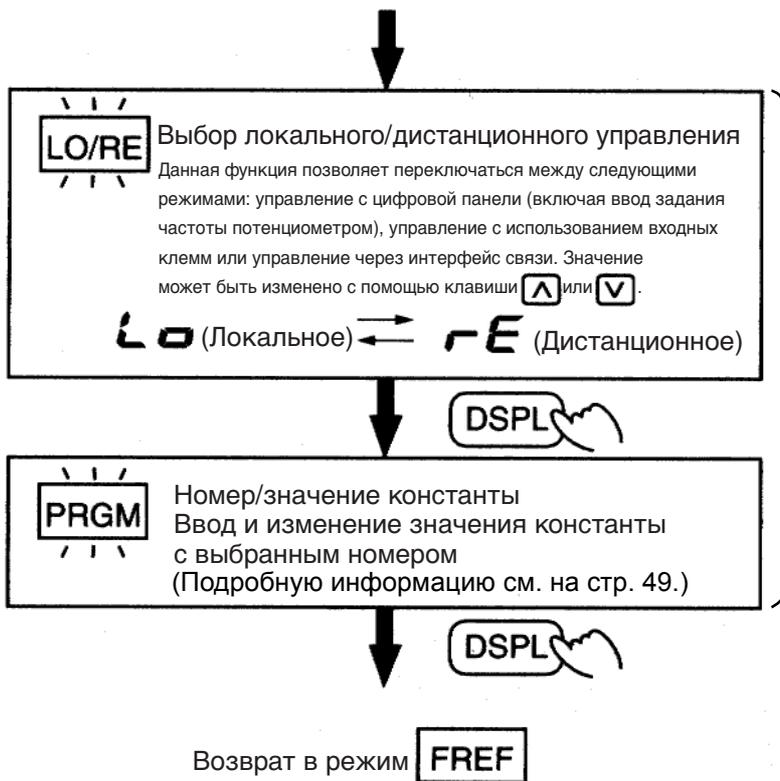
Если инвертор V7AZ останавливается во время работы после переключения в любой из этих режимов, он переходит из режима «Привод» в режим «Программирование». В данном случае инвертор V7AZ не начнет работать даже при повторной подаче команды «Ход». В то же время, если  $n001=5$ , при получении команды «Ход» инвертор V7AZ начнет работу.
