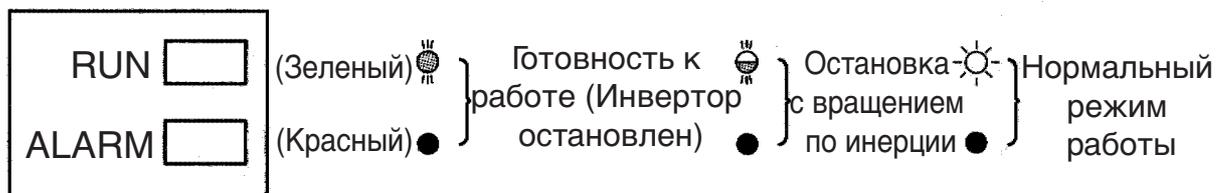
В следующей таблице перечислены состояния инвертора и соответствующие им комбинации состояний индикатора клавиши RUN (Ход) цифровой панели управления и индикаторов RUN (Ход) и ALARM (Ошибка) на лицевой панели инвертора V7AZ.
