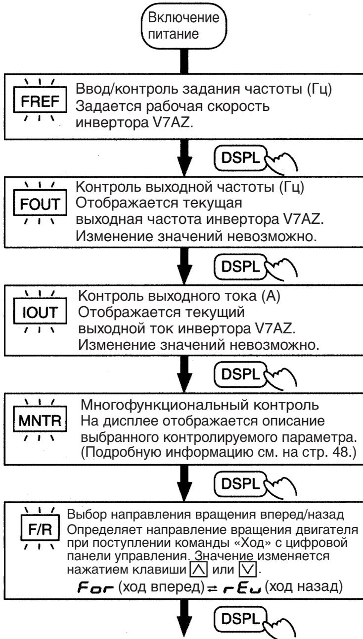
Если при работе инвертора V7AZ в одном из этих режимов прерывается электропитание, при возобновлении электропитания инвертор вновь возвращается в тот же режим.
