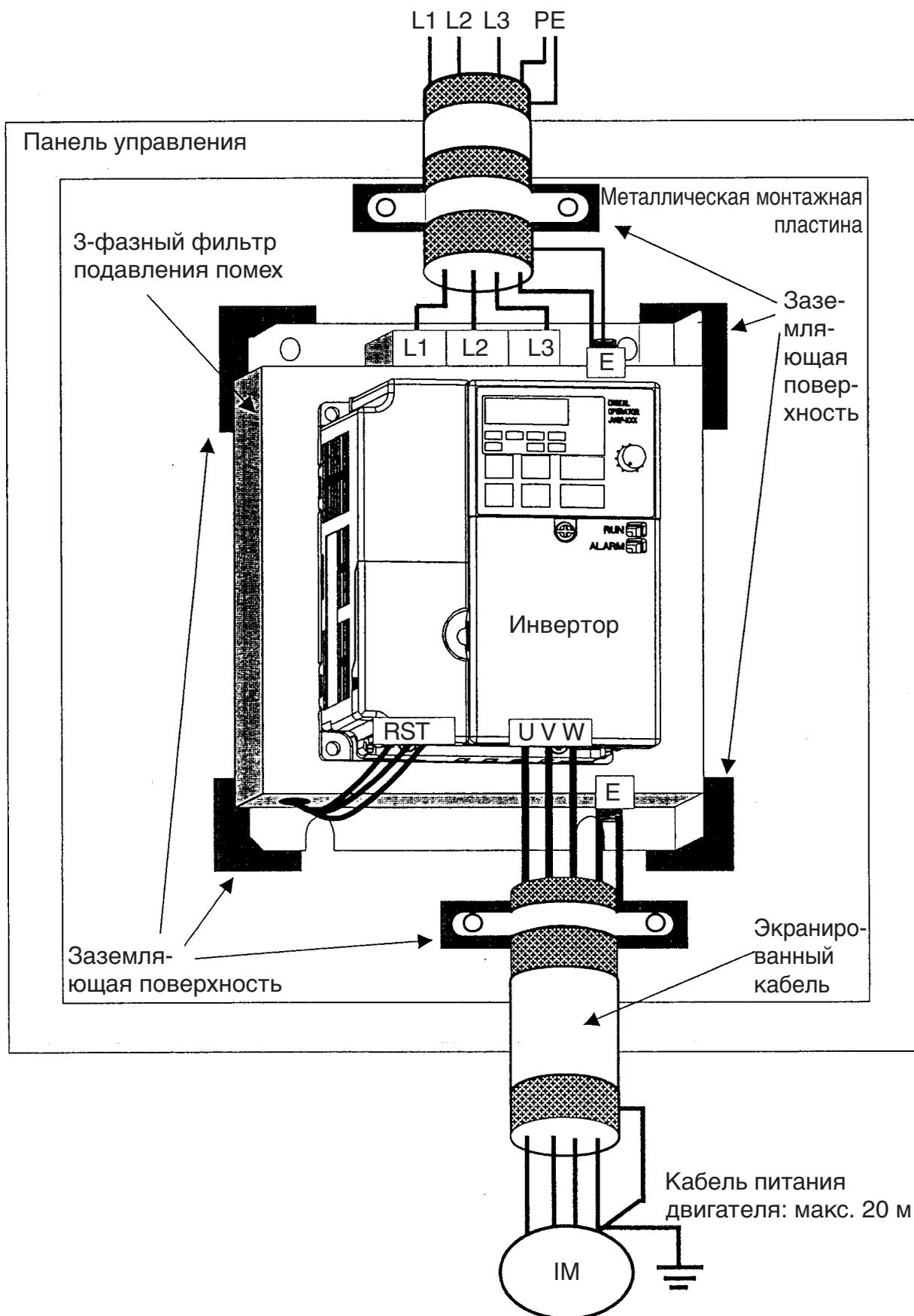
Установка и подключение инвертора и фильтра
