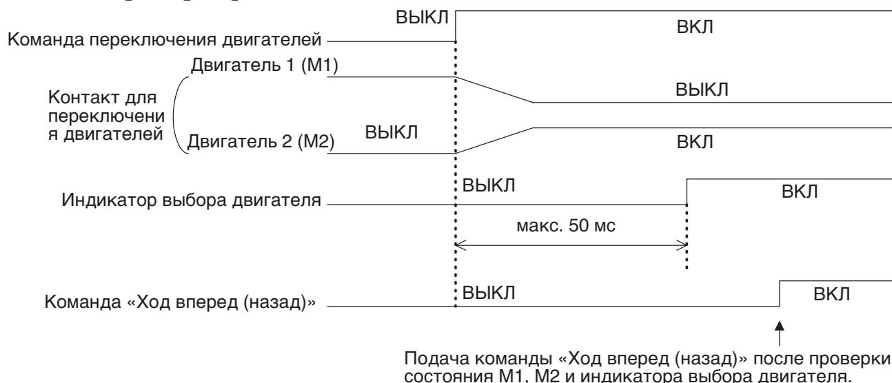
Если подача команды «Ход вперед (назад)» происходит сразу после подачи (или отключения) команды переключения двигателей, но до включения (или выключения) индикатора выбора двигателя, то инвертор начнет подачу электропитания на двигатель сразу же после включения (или выключения) индикатора выбора двигателя.
