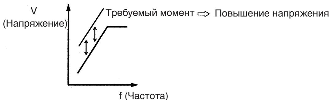
Коэффициент усиления для компенсации момента (n103, заводское значение: 1,0), как правило, изменять не требуется. Если инвертор находится на большом расстоянии от двигателя или двигатель вибрирует при работе, измените коэффициент усиления для функции автоматического «подъема» момента. В этом случае настройте V/f-характеристику (n011 ... n017).
