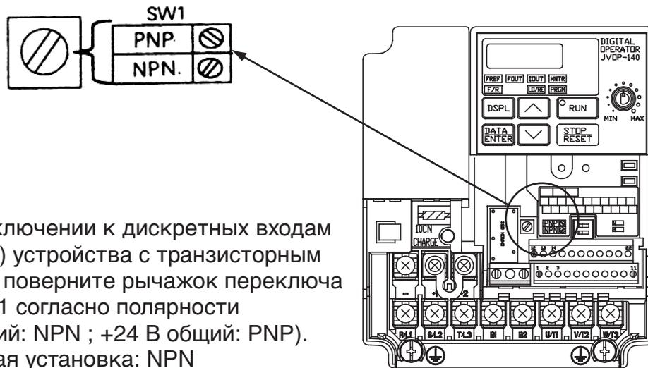
При подключении к дискретным входам (S1 ... S7) устройства с транзисторным выходом поверните рычажок переключателя SW1 согласно полярности (0 В общий: NPN ; +24 В общий: PNP).
