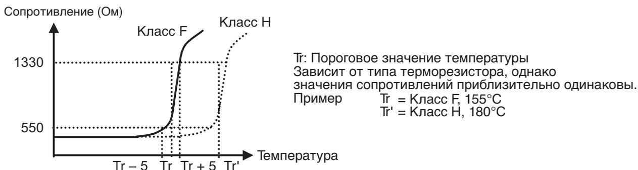
Напряжение между выводами трех соединенных последовательно терморезисторов поступает на клеммы аналогового входа (FR), и в зависимости от этого напряжения с учетом характеристики терморезистора формируются предупреждения о перегреве двигателя (ОН) и сигнализируются ошибки перегрева двигателя (ОН).
