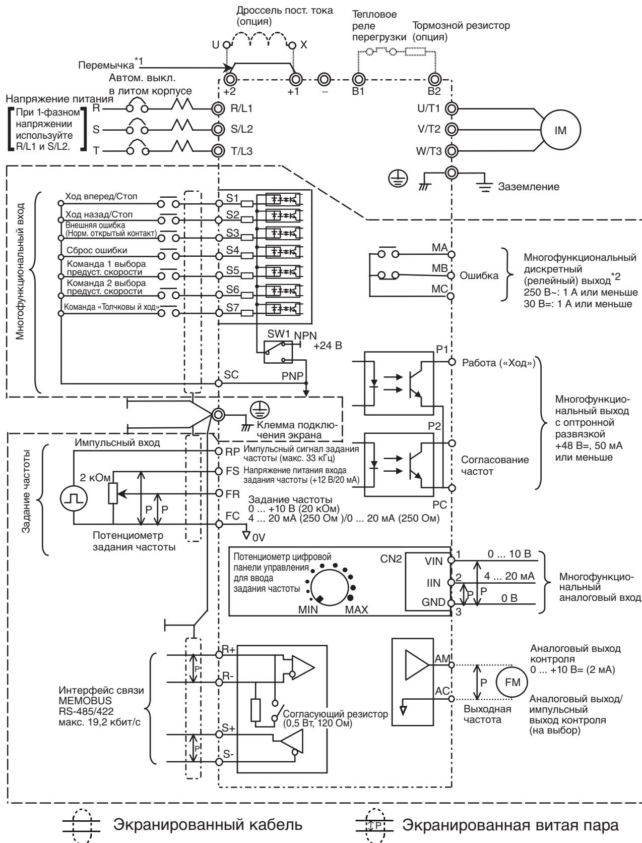
Для клемм схемы управления предусмотрена только базовая изоляция (класс защиты 1, категория защиты от перенапряжения II). Для обеспечения соответствия требованиям CE в конечной системе, возможно, потребуется предусмотреть дополнительную изоляцию.
