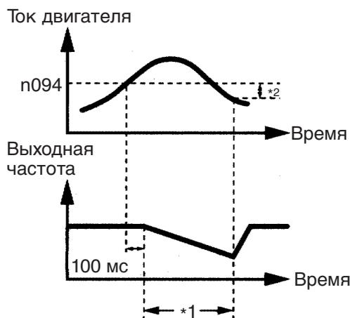
\*1: Уменьшает частоту для предотвращения опрокидывания ротора.
