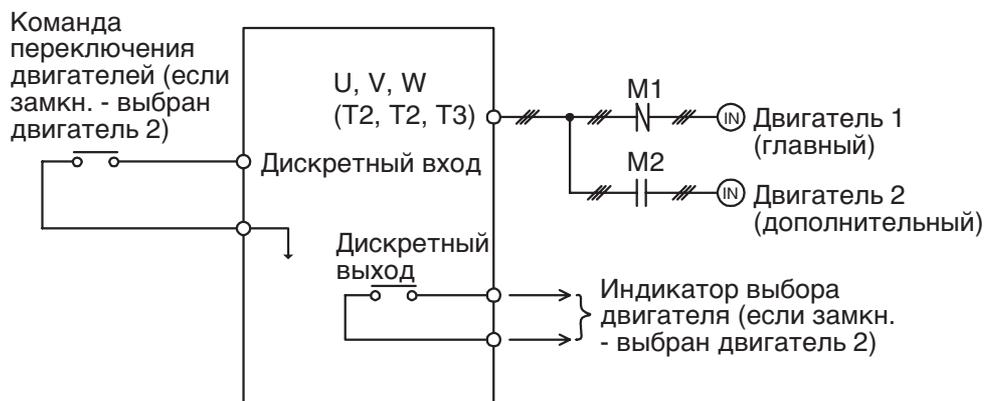
Примечание: Для переключения между двигателем 1 и двигателем 2, а также для проверки состояния двигателей должны подаваться внешние команды управления.
