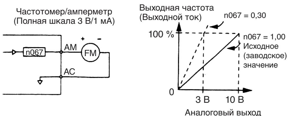
Установите на аналоговом выходе напряжение при уровне выходной частоты (выходного тока) 100 %. Частотомер показывает частоту 0 ... 60 Гц при напряжении 0 ... 3 В.
