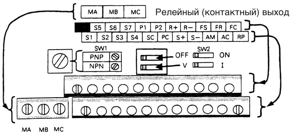
Положение переключателя SW1 можно изменить в соответствии с полярностью входного сигнала (S1 ... S7).
