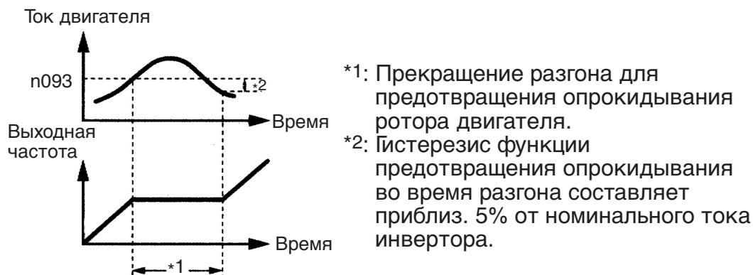
В области постоянной выходной частоты (выходная частота > выходной частоты при максимальном напряжении (n013)) уровень предотвращения опрокидывания ротора (ограничение тока) во время разгона автоматически снижается согласно следующей формуле.
