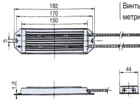
Блок тормозного резистора (устанавливаемый отдельно)
