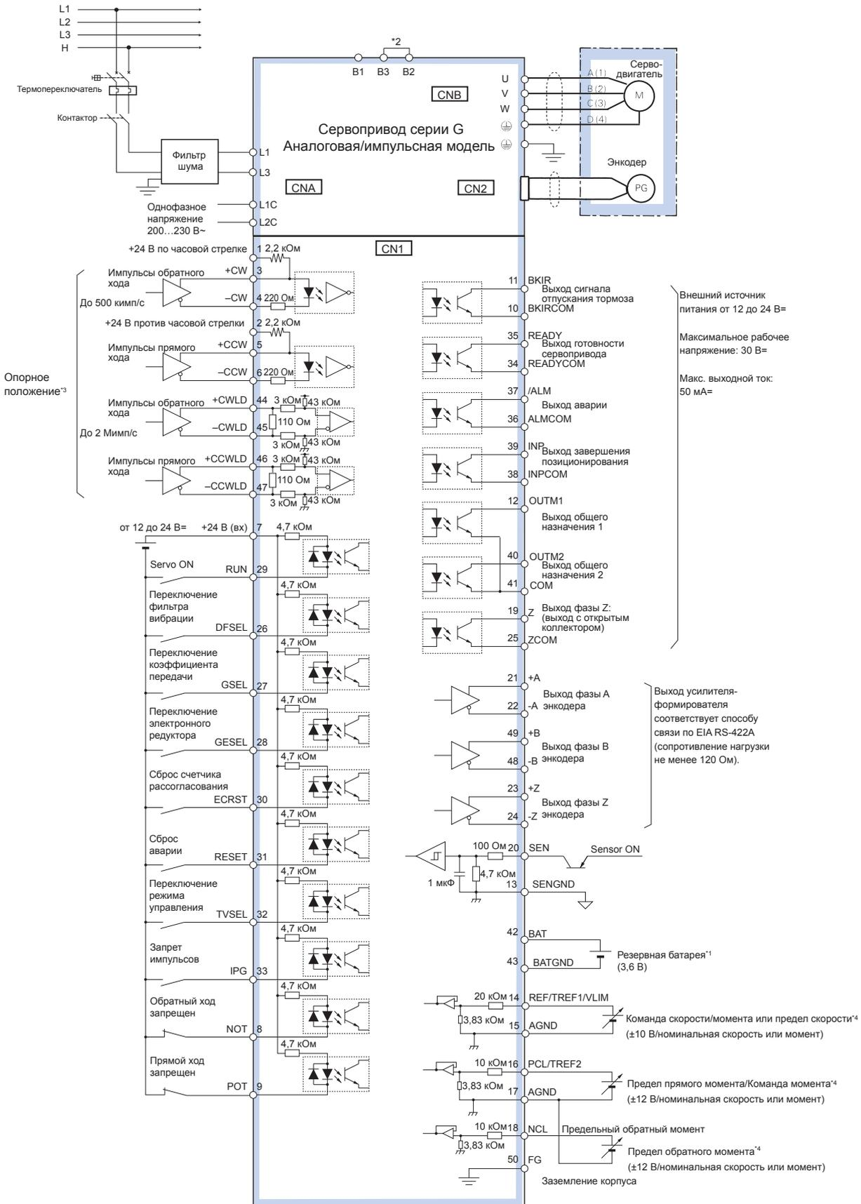
\*1 Используется только с абсолютным энкодером. Если резервная батарея подключена к разъему входа/выхода CN1, кабель энкодера с батарей не нужен.
