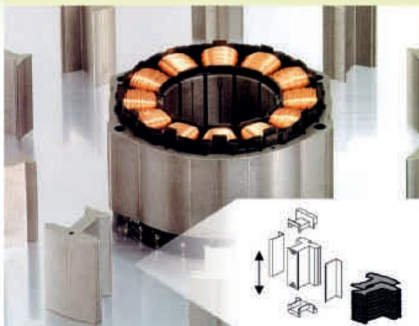
В серводвигателях используются составные сердечники для увеличения плотности намотки, что позволяет достичь того же магнитного потока в меньшем объеме. Так же Omron применяет технологию PACK & CLAMP («упаковать и зажать»), увеличивающую плотность пакета статора серводвигателя и снижающую потери на 40%. Пластины статора упаковываются, а затем просто зажимаются.
