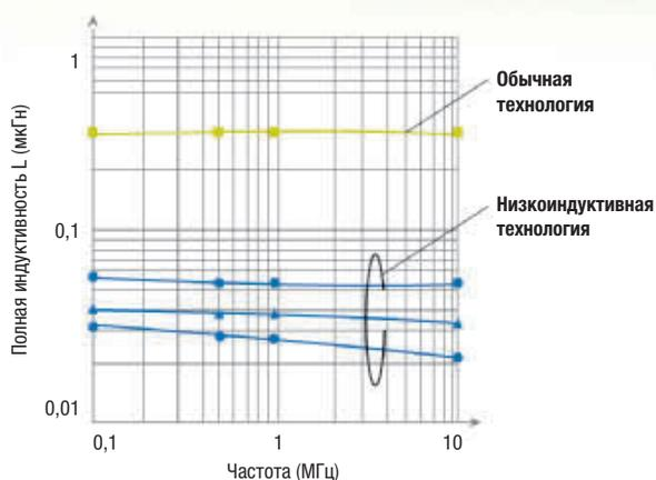
Новая серия инверторов была разработана для гарантированной непрерывной работы в течение 10 лет. Конструкция с силовой цепью низкой индуктивности (LIPC, Low Inductance Power Circuit) дает большое снижение потерь в IGBT и шунтирующих диодах. Это увеличивает срок службы силовых компонентов и снижает воздействие при работе на высокой частоте.
