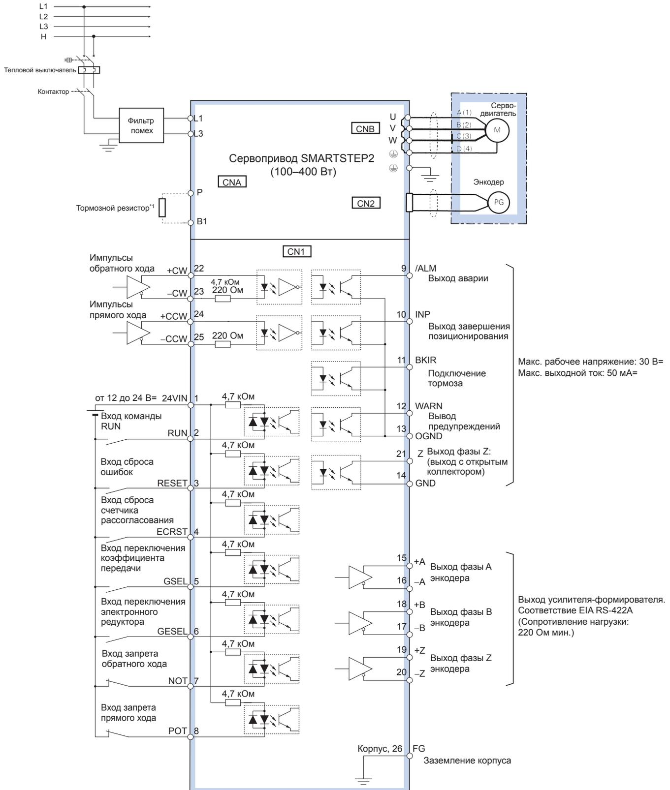
\*1. Возможно подключение резистора внешней регенерации. Подключите этот резистор при недостаточной мощности рассеяния сервопривода.
