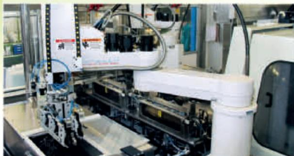
2 SCARA-робота для захвата и переноса
