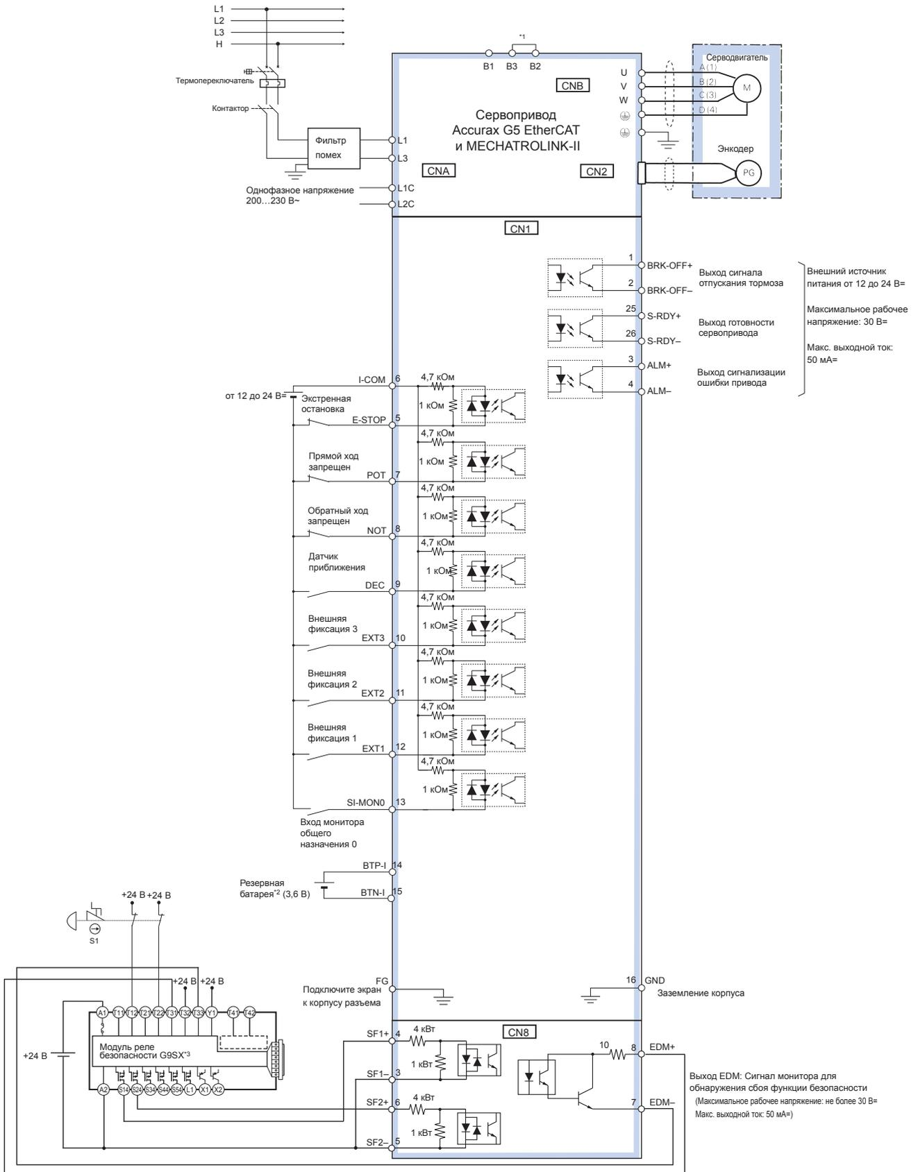
\*1 Для сервоприводов от 750 Вт B2 и B3 замкнуты. Если внутреннего тормозного резистора недостаточно, удалите провод между B2 и B3 и подключите внешний тормозной резистор между B1 и B2.
