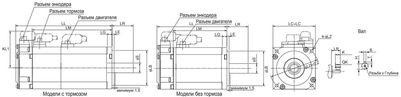
Серводвигатели 3000 об/мин (230 В, 1–1,5 кВт/400 В, 750 Вт–5 кВт)
