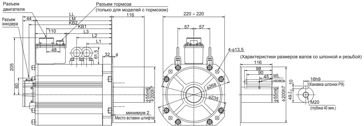
Серводвигатели 1000 об/мин (230 В, 900 Вт/400 В, 900 Вт–3 кВт)
