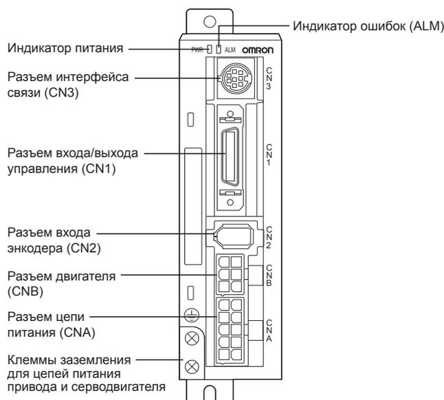
Сервопривод SmartStep2 (модели 750 Вт)
