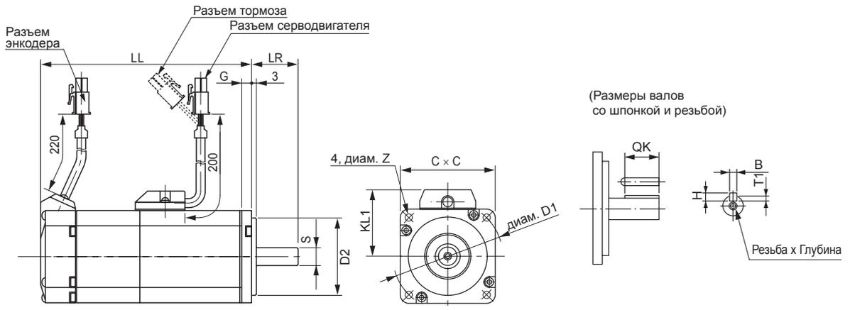
Цилиндрический тип 3000, 2000 и 1000 об/мин (230 В, 0,9–1,5 кВт)
