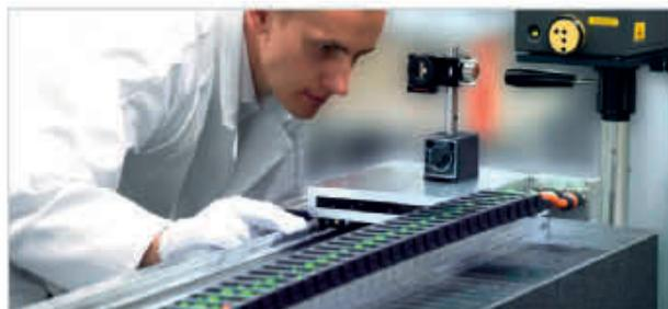
Точные измерения с помощью лазерного интерферометра для обеспечения качества при создании данных для распределения этапов.
