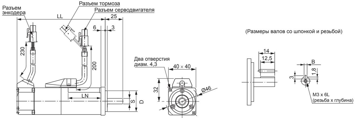
Цилиндрический тип 3000 об/мин (230 В, 200–750 Вт)
