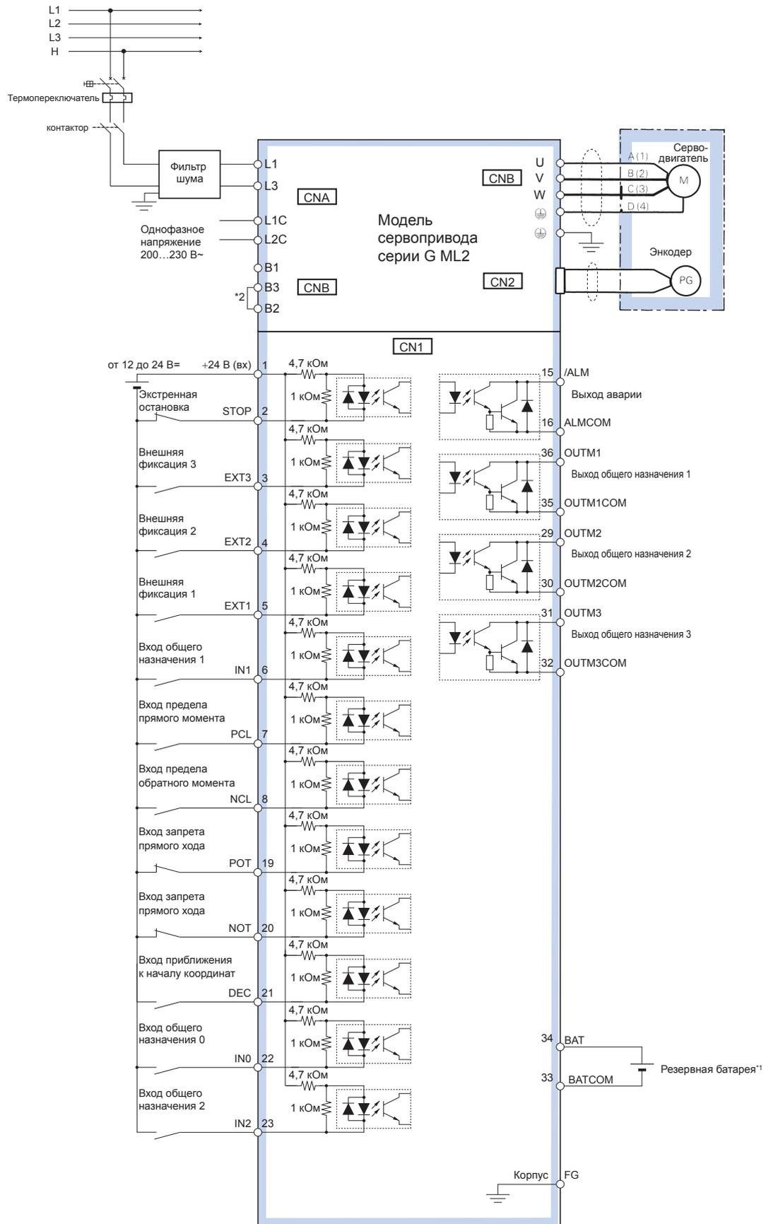
\*1 Используется только с абсолютным энкодером. Если резервная батарея подключена к разъему входа/выхода CN1, кабель энкодера с батареей не нужен.
