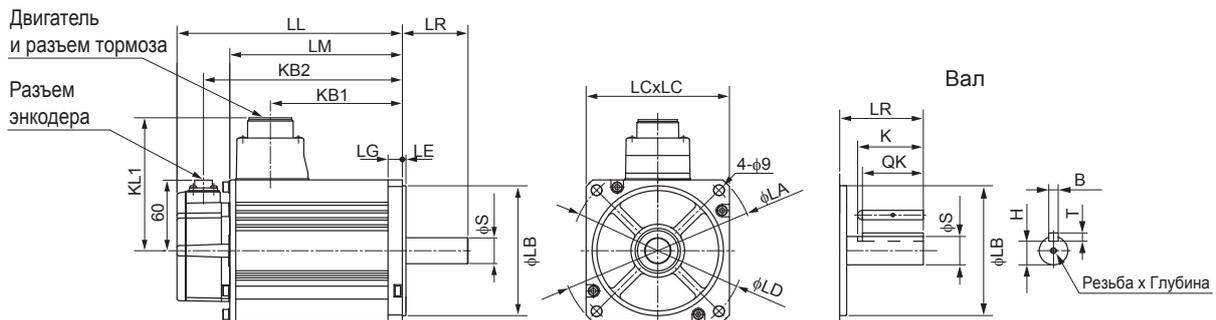
Серводвигатели 2000 об/мин (230 В, 1–1,5 кВт/400 В, 400 Вт–5 кВт)
