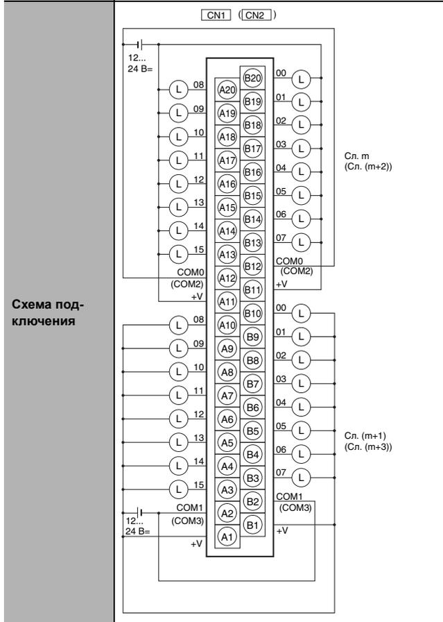
**Примечание.** Пары одноименных выводов +V и COM соединяются внутри ПЛК, однако все они должны быть подключены к внешней цепи.
