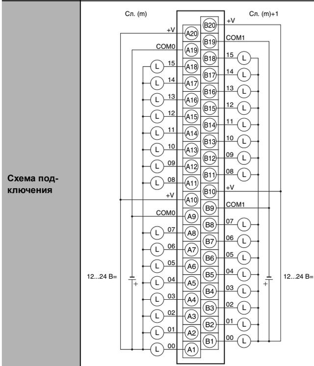
**Примечание.** Пары одноименных выводов +V и COM соединяются внутри ПЛК, однако все они должны быть подключены к внешней цепи.
