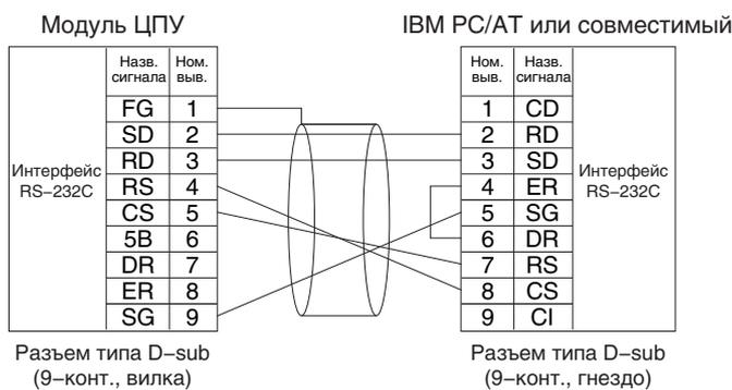
A-4 Подключение к последовательному порту модуля ЦПУ
