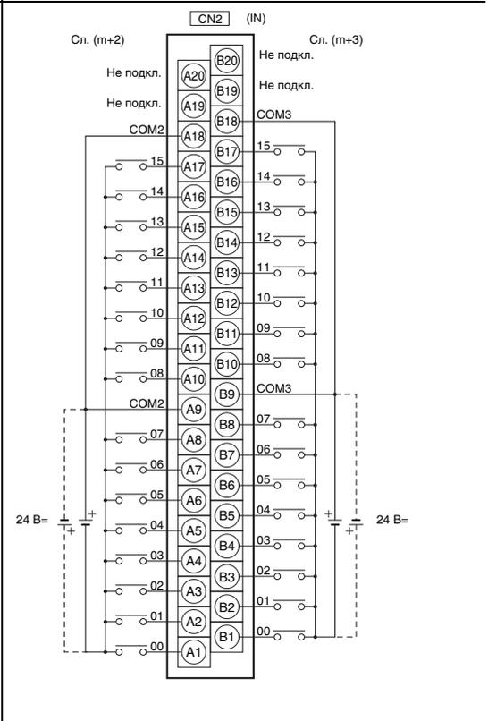
**Примечание.** Пары одноименных выводов +V и COM соединяются внутри ПЛК, однако все они должны быть подключены к внешней цепи.
