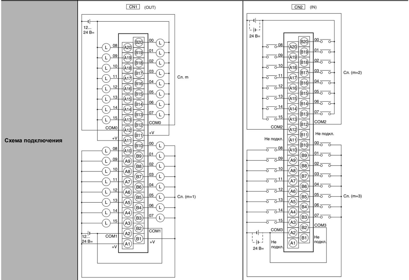
**Примечание.** Пары одноименных выводов +V и COM соединяются внутри ПЛК, однако все они должны быть подключены к внешней цепи.
