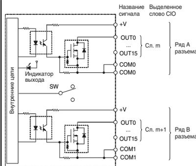
Расположение и схема подключения клемм (выводов)
