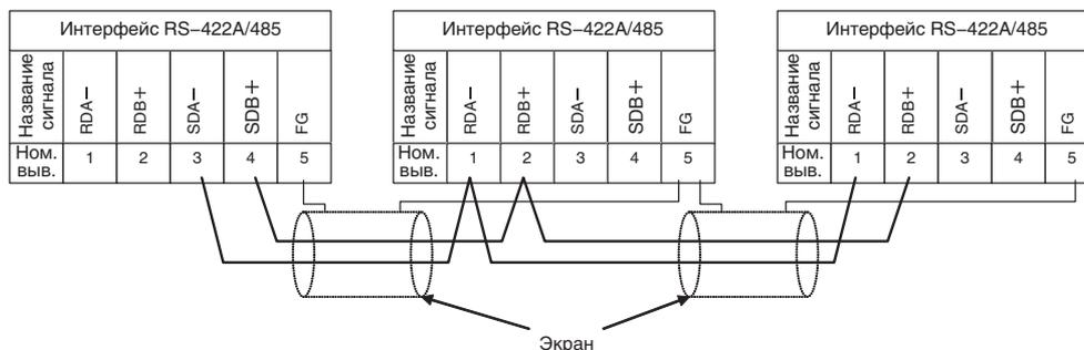
● Подключение для проверки отклика
