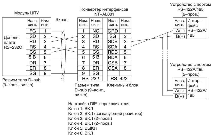
\*1 Рекомендуем использовать следующие кабели для подключения к конверторам интерфейсов NT-AL001 (Link Adapter).
