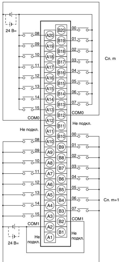
**Примечание.1** Источники питания входов, обозначенные прерывистыми линиями (-----), могут быть подключены с любой полярностью, но полярность подключения должна быть одинаковой для обеих групп входов.
