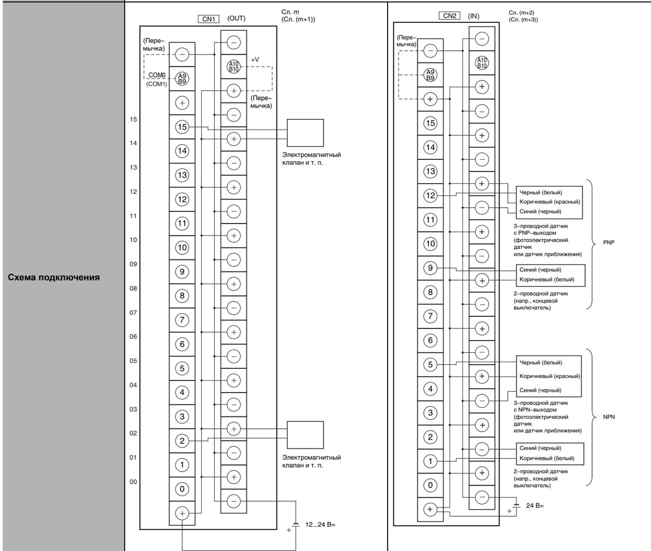
**Примечание.1** Соедините вывод A9/B9 с выводом ⊖. Соедините вывод A10/B10 с выводом ⊕. (Используйте прилагаемую перемычку.)
