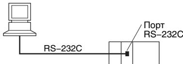
**Примечание.** Длина кабеля интерфейса RS-232C не должна превышать 15 м. Однако скорость передачи 19,2 Кбит/с спецификациями RS-232C не предусмотрена. Уточните возможность использования данной скорости передачи в документации на подключаемое устройство.
