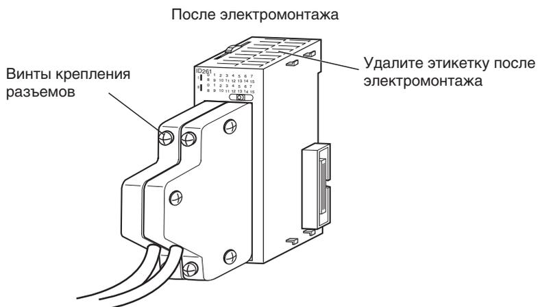
Затяните винты крепления разъема с моментом затяжки 0,2 Н·м.
