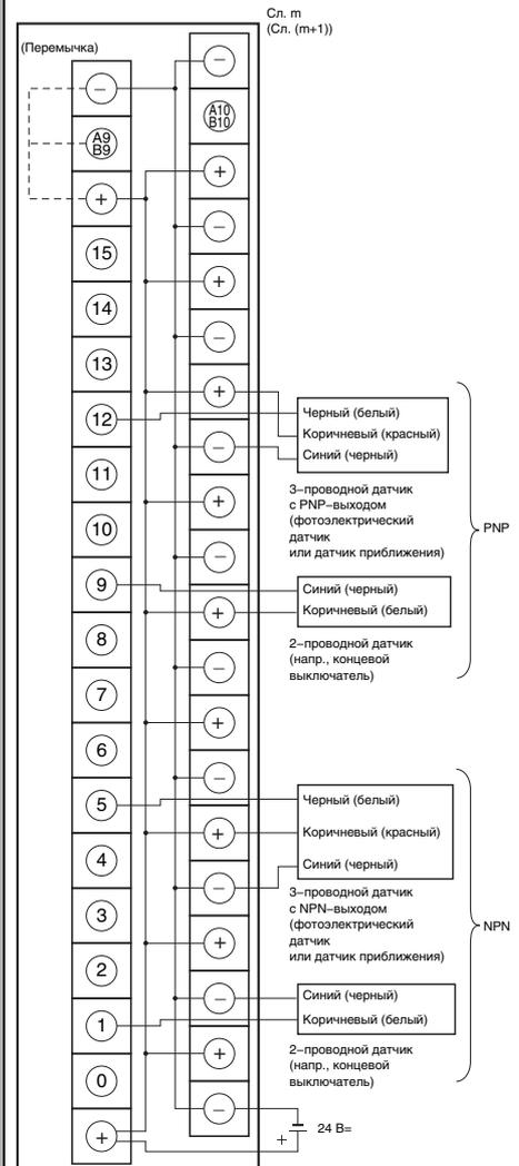
**Примечание.1** Для NPN соедините вывод A9/B9 с выводом ⊕.
