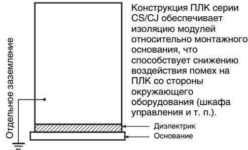
Пример: изоляция и заземление корпуса
