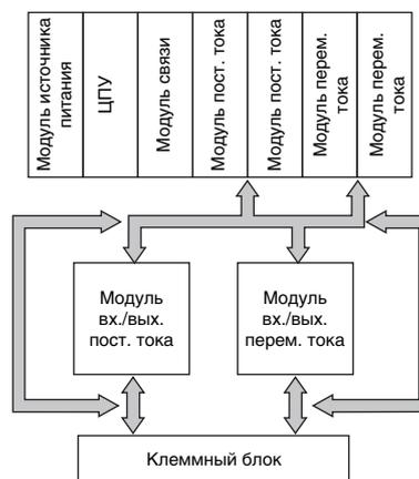
Пример компоновки внутри шкафа
