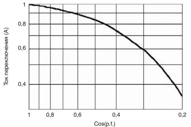
Для индуктивных нагрузок (таких как соленоиды, контакторные катушки и др.) коэффициент снижения, соответствующий cos(p.f.) (косинус коэффициента мощности), умножается на величину номинального тока для получения максимально допустимого тока. Эта формула неверна для нагрузок с высоким пусковым током, таких как электродвигатели или флюоресцентные лампы.
