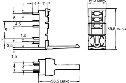
**Расположение клемм (вид снизу)**
