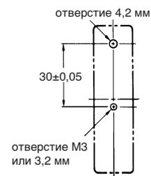
**Монтажная высота реле с цоколем для монтажа на шинах и монтажной плате**
