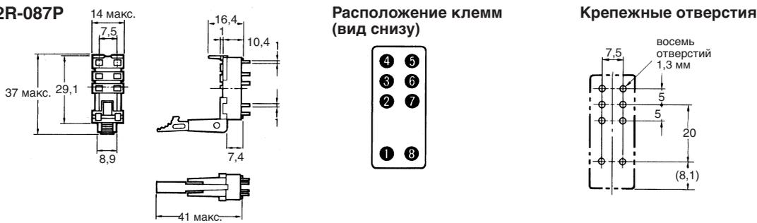
**Монтажная высота реле и цоколя с разъемами сзади**
