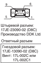
Назначение выводов и параметры разъема датчика Холла
