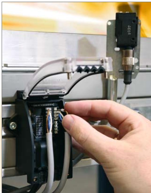
▲ Просто вставьте наконечники проводников кабеля ввода/вывода в клеммы, закройте крышку – и все!
