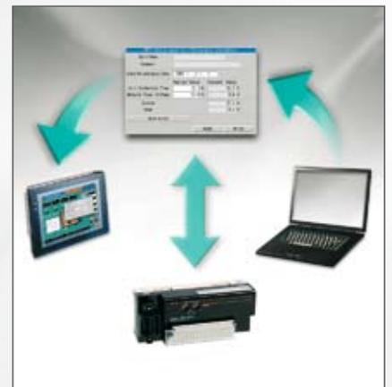
▲ Информацию от интеллектуального модуля ввода/вывода можно получать и отображать на экране программируемого терминала серии NS компании Omron. Для этого достаточно разместить на экранной форме соответствующие Интеллектуальные активные компоненты (SAP) (готовые программные модули).
