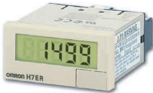
Модели серии H7E оснащены большим ЖК-дисплеем с высотой символов 8,6 мм. Серия также включает модели с задней подсветкой индикатора, повышающей видимость показаний в условиях плохого освещения. В семейство H7E входят суммирующие счетчики, таймеры и тахометры, а также счетчики, предназначенные для монтажа на печатную плату.
