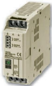
Предотвращает остановку оборудования, потерю данных и другие неполадки, вызываемые кратковременными перебоями питания. Один буферный блок S8T-DCBU-02 обеспечивает подпитку в течение 500 мс при выходном токе 2,5 А. Может подключаться к выходу 24 В= любого импульсного источника питания.
