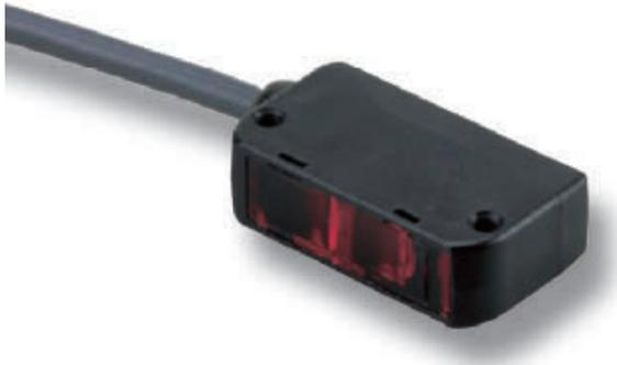
Специальная оптическая система датчика E3S-LS3 с широкой диаграммой направленности луча и ограниченной зоной отражения гарантирует надежное обнаружение структурированных объектов (объектов различной высоты, объектов с отверстиями), что позволяет применять этот датчик для обнаружения таких объектов, как, например, печатные платы.
