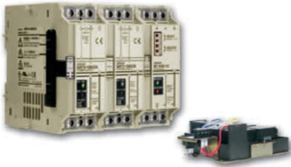
Блок аварийной поддержки питания S8T-DCBU-01 осуществляет подачу напряжения питания 24 В= в течение ограниченного времени при отсутствии напряжения в электросети, что существенно повышает надежность системы.
