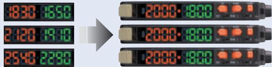
Мощность свечения светодиода и интенсивность принимаемого света может быть увеличена или уменьшена до требуемого уровня (например, до заданного значения).
