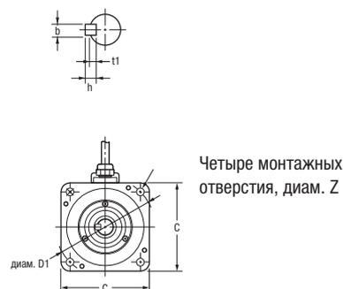
Четыре монтажных отверстия, диам. Z
