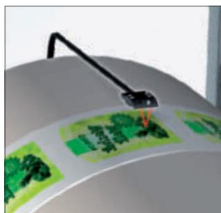
Малогабаритные датчики с ограниченной зоной отражения обеспечивают высокую точность обнаружения с разрешением до 100 мкм и позволяют обнаруживать мельчайшие перепады высоты (например, наличие этикеток на пленке) в условиях ограниченного пространства.
