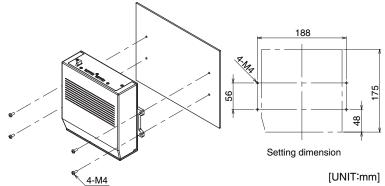
Tightening torque : 1.2N·m
