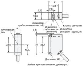
Кабель круглого сечения, диаметр 4, с виниловой изоляцией, с 4-мя жилами (поперечное сечение жилы: 0,2 мм² (AWG.24), диаметр изоляции: 1,1 мм); стандартная длина: 2 м
