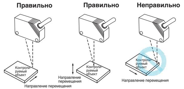
Если контролируемые объекты значительно отличаются цветом и материалом, установите датчик как показано на следующем рисунке.
