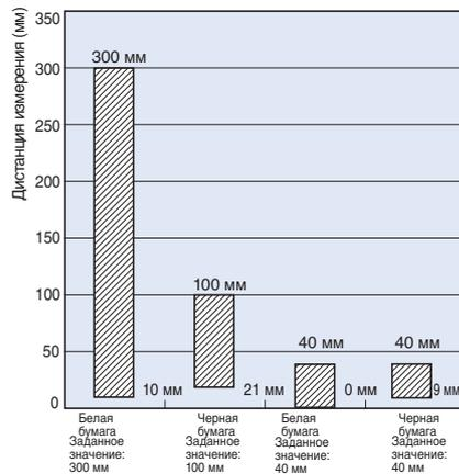
Зависимость дистанции измерения от материала контролируемого объекта
