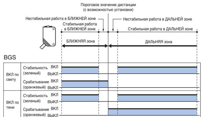
Примечания: Если индикатор стабильности горит, то при нормальной температуре окружающего воздуха (от -10 до 55 °C) определение состояния "обнаружен"/"не обнаружен" выполняется стабильно.
