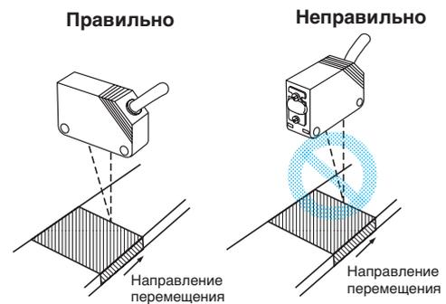
**Регулировка моделей с установкой дистанции измерения**
