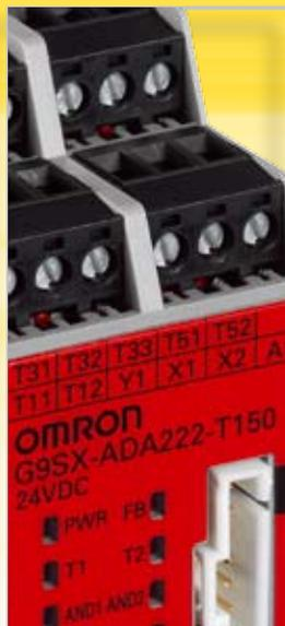
Клеммы могут быть двух типов: с винтовыми или пружинными зажимами.
