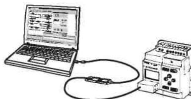
**Примечание:** При использовании портативного компьютера, не имеющего последовательного порта RS-232C, подключить компьютер к модулю ZEN посредством соединения кабеля-переходника «последовательный порт – USB» CS1W-CIF31 OMRON с соединительным кабелем ZEN-CIF01.
