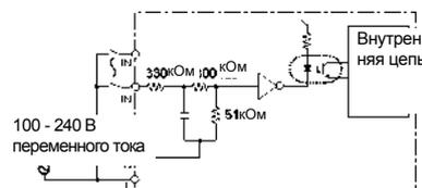
Примечание: Задается при помощи выбора параметров фильтрации.
