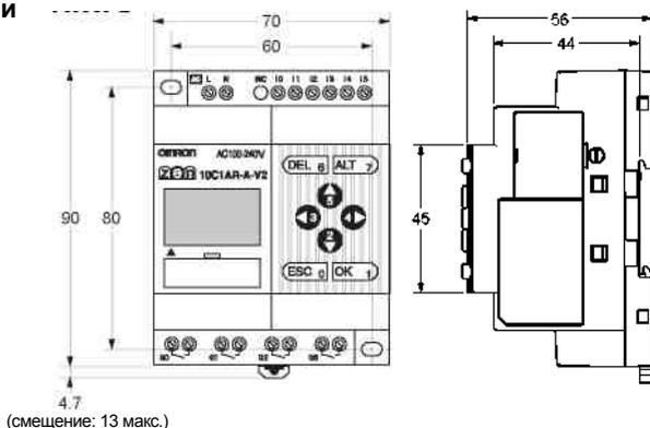
Монтажные отверстия модуля
