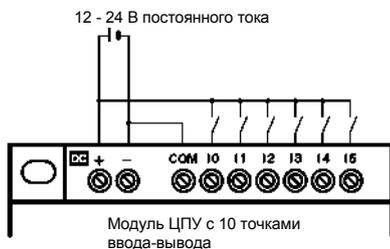
Для подключения устройств аналогового ввода к входным клеммам I4 и I5
