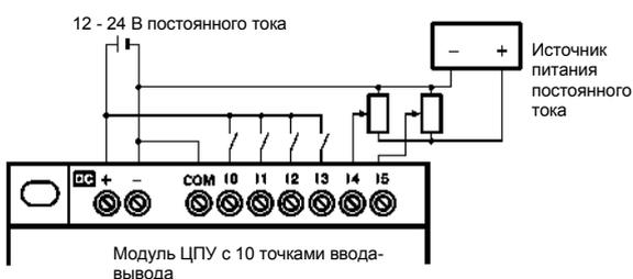
**Примечание:** При подключении устройства аналогового ввода всегда подключать отрицательный вывод к клемме COM.
