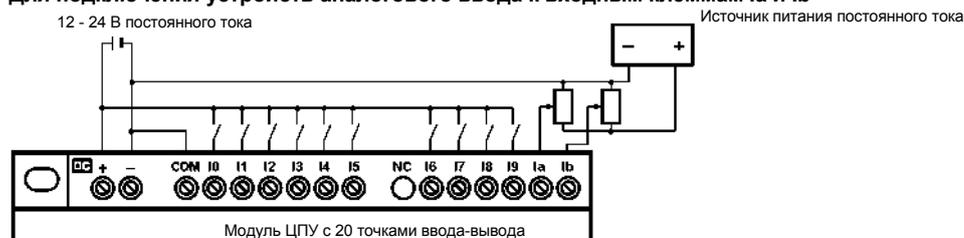
**Примечание:** При подключении устройства аналогового ввода всегда подключать отрицательный вывод к клемме COM.
