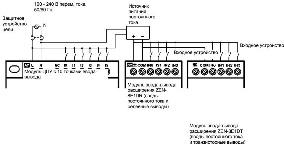
**Примечание:** При подключении модулей ввода-вывода расширения с вводами постоянного тока к модулю ЦПУ с источником питания переменного тока устойчивость к импульсным помехам будет составлять 1 кВ (IEC 61000-4-4).
