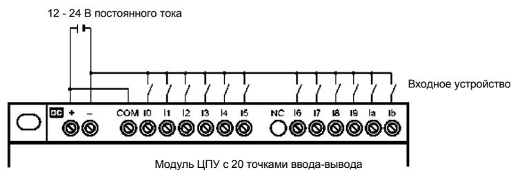
**Примечание:** При подключении к положительному общему проводу (+) клеммы I4 и I5 не могут быть использованы в качестве аналоговых вводов.
