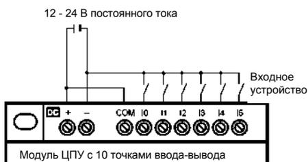
**Примечание:** При подключении к положительному общему проводу (+) клеммы I4 и I5 не могут быть использованы в качестве аналоговых вводов.
