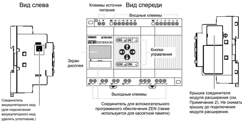
**Примечание: 1.** С модулями ЦПУ с возможностью подключения связи клемма Q3 используется как клемма для RS-485. Подробности приводятся в разделе "Соединения на выводах" на стр. 15.
