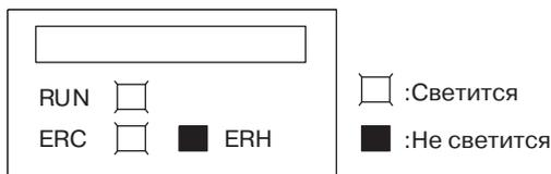
Если при работе модуля в обычном режиме происходит ошибка, светятся индикаторы ERC и RUN. При этом в слове CIO (n+9) будут установлены флаги ошибок, указанные ниже. Эти флаги ошибок сбрасываются автоматически после устранения ошибки.
