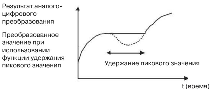
Функцию удержания пикового значения можно включить отдельно для каждого входа, установив соответствующие биты (04 ... 07) в слове СЮ (n).
