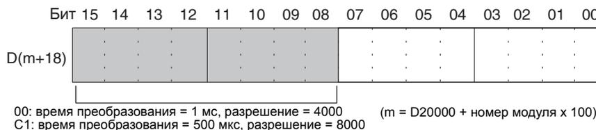
**Примечание** Выполнив настройки в области DM с помощью средства программирования, необходимо либо выключить и вновь включить питание ПЛК, либо установить Бит перезапуска модуля специального ввода/вывода, чтобы содержимое настроек DM было передано специальному модулю ввода/вывода.
