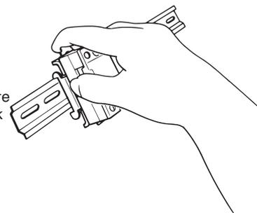
Чтобы снять реле с DIN-рейки, вытяните язычок фиксатора с помощью отвертки в направлении, указанном стрелкой.
