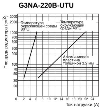
**Замечание:** Под площадью радиатора понимается общая площадь всех участков поверхности радиатора, рассеивающих тепло. Например, если при температуре 40°C через реле протекает ток 18 А, то (как следует из графика) площадь теплоотвода должна составлять около 450 см<sup>2</sup>. Следовательно, если радиатор имеет квадратную форму, то его сторона должна составлять не менее  $15 \text{ см } (\sqrt{450 \text{ (см}^2\text{)}}/2)$ .
