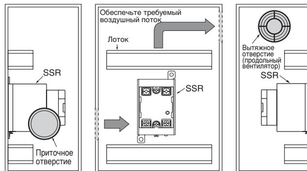
Если в приточном или вытяжном вентиляционном отверстии установлен фильтр, для обеспечения достаточного притока воздуха фильтр необходимо регулярно очищать, предотвращая его засорение.
