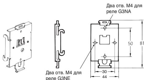
Чтобы установить реле на DIN-рейку, сначала установите реле на пластину ускоренного монтажа, а затем закрепите пластину на DIN-рейке, как показано на рисунке.
